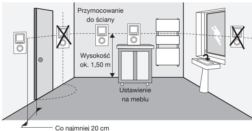
Aby uzyskać optymalne ustawienie temperatury otoczenia, należy zainstalować termostat w tym samym pomieszczeniu co sterowane przez nie urządzenie lub urządzenia. Fale radiowe mogą pokonać przeszkody (meble, ścianki...) w zasięgu od 100 do 300 metrów na wolnej przestrzeni, zależnie od warunków instalacji i środowiska elektromagnetycznego.
