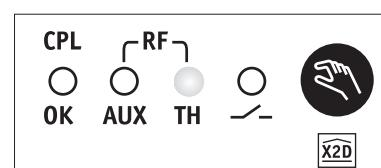
Het lampje brandt onafgebroken als het aansluitingssignaal van de thermostaat wordt waargenomen.
