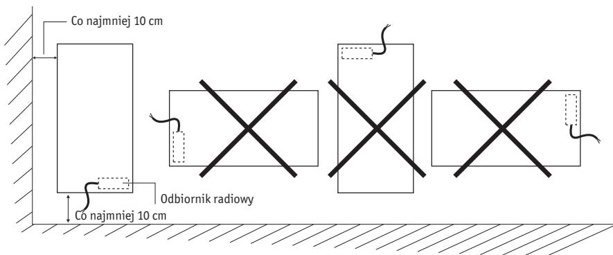
**WAŻNE** Grzejnik ten nie powinien być nigdy instalowany z układem zasilającym do góry. Umieścić dół grzejnika na wysokości wynoszącej co najmniej 10 cm od podłoża.
