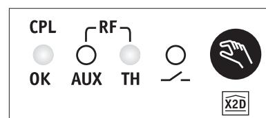
Het controlelampje CPL gaat onafgebroken branden als het signaal van aansluiting op de PLC centrale wordt waargenomen.
