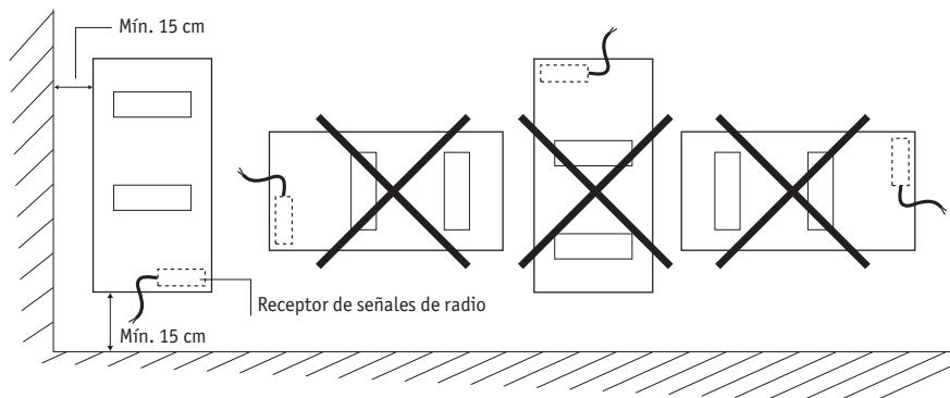
**IMPORTANTE** Este secatoallas no debe instalarse nunca con su caja de alimentación en una posición alta. Colocar la parte inferior del secatoallas a 15 cm del suelo como mínimo.
