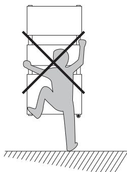
**WARNUNG BEI EINSATZ VERCHROMTER, EDELSTAHL- ODER ALUMINIUMGERÄTE** Unter den verschiedenen Oberflächenqualitäten besitzen verchromte Heizkörper sowie Edelstahl- und Aluminiumgeräte die wärmste Oberfläche beim Berühren. Es wird davon abgeraten, sich im Betrieb auf der Vorderseite des Geräts abzustützen, um Verbrennungen zu vermeiden.
