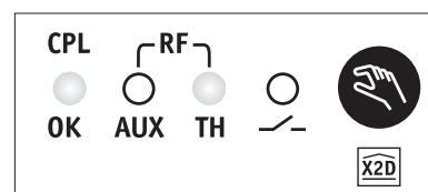
La spia CPL diventa fissa quando il segnale di associazione della centralina di programmazione viene rilevato.
