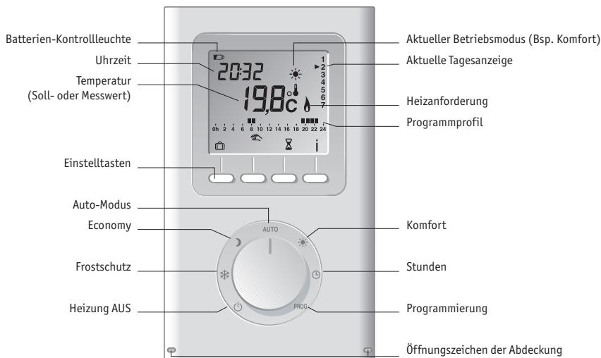
**ACHTUNG** Der Heizkörper ist mit keiner anderen Steuervorrichtung als mit dem mitgelieferten Raumthermostat kompatibel.
