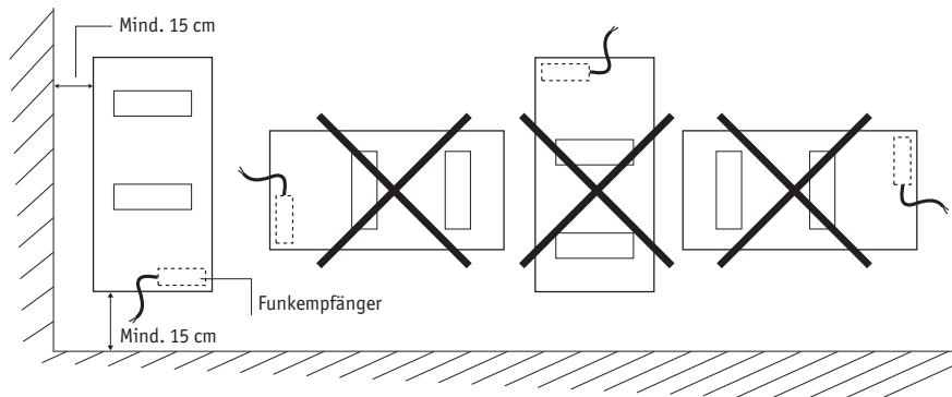
**BITTE BEACHTEN** Der Handtuchtrockner darf in keinem Fall mit der Versorgungseinheit oben installiert werden. Darauf achten, dass die Unterseite des Handtuchtrockners mindestens 15 cm vom Boden liegt.
