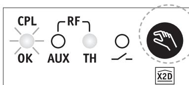
Wskaźnik TH nie migra (grzejnik jest połączony z termostatem), wskaźnik PLC migra w oczekiwaniu na połączenie z układem PLC.
