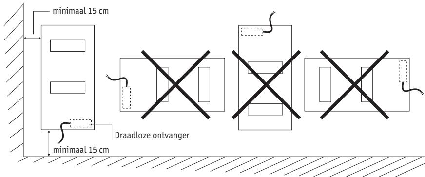
**BELANGRIJK** Deze handdoekradiator nooit met voedingsdoos aan de bovenkant installeren. Plaats de onderkant van de handdoekradiator minimaal 15 cm boven de vloer.
