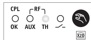
Die Leuchte brennt stetig, wenn das Verknüpfungssignal des Thermostats empfangen wird.
