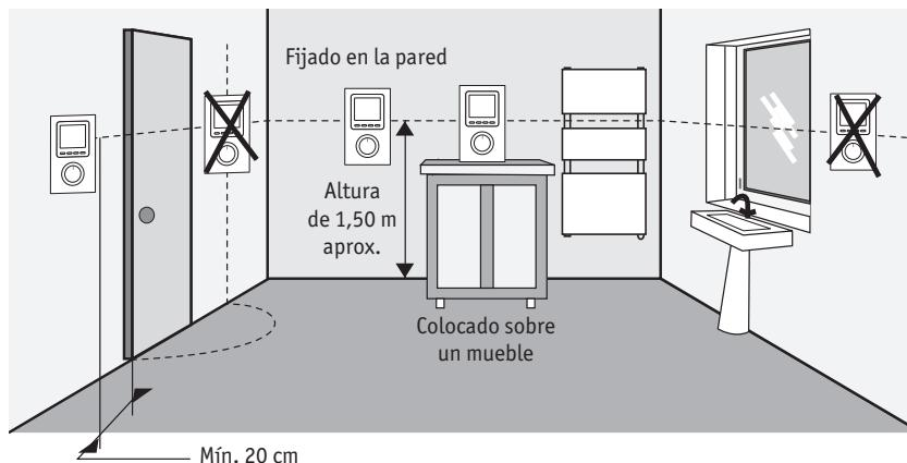
Para un ajuste óptimo de la temperatura ambiente, el termostato debe instalarse en la misma estancia que el o los aparatos que controla. La emisión vía radio permite atravesar los obstáculos (mobiliario, tabiques...) de 100 a 300 metros en campo libre, variable en función de las condiciones de instalación y del entorno electromagnético.
