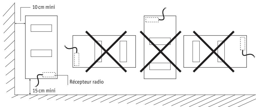
**IMPORTANT** Ce sèche-serviettes ne doit jamais être installé avec son boîtier d'alimentation en position haute. Positionner le bas du sèche-serviettes au minimum à 15 cm du sol.
