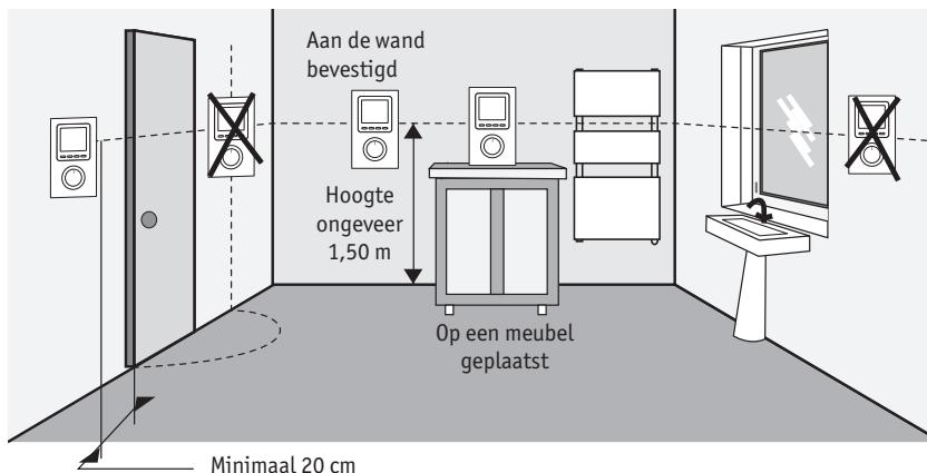
Voor optimale regeling van de kamertemperatuur moet de thermostaat in hetzelfde vertrek worden geïnstalleerd als het/de toestel(len) dat/die door de thermostaat word(en) aangestuurd. De radiogolven kunnen in een vrij veld door obstakels (meubels, scheidingswanden, enz.) van 100 tot 300 meter worden verzonden afhankelijk van de omstandigheden van de installatie en de elektromagnetische omgeving.
