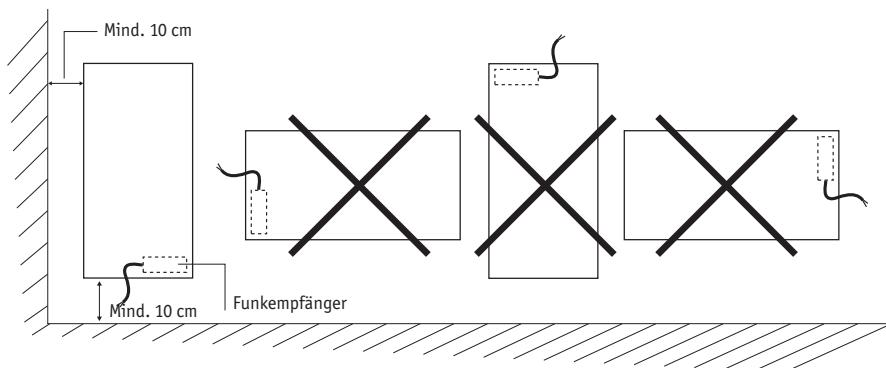
**BITTE BEACHTEN** Der Heizkörper darf in keinem Fall mit der Versorgungseinheit oben installiert werden. Darauf achten, dass die Unterseite des Heizkörpers mindestens 10 cm vom Boden liegt.
