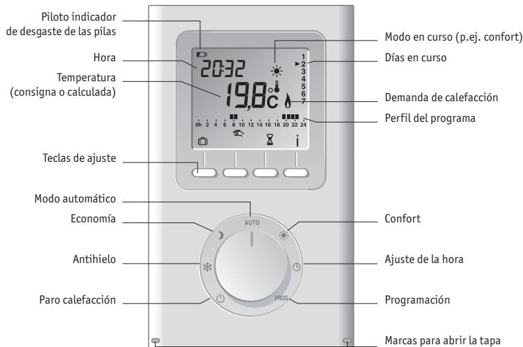
**ATENCIÓN** El radiador no es compatible con un dispositivo de control que no sea el termostato de ambiente suministrado.
