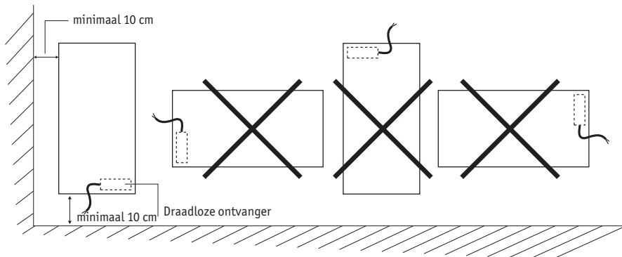
**BELANGRIJK** Installeer deze radiator nooit met de voedingsdoos aan de bovenkant. Plaats de onderkant van de radiator minimaal 10 cm boven de vloer.
