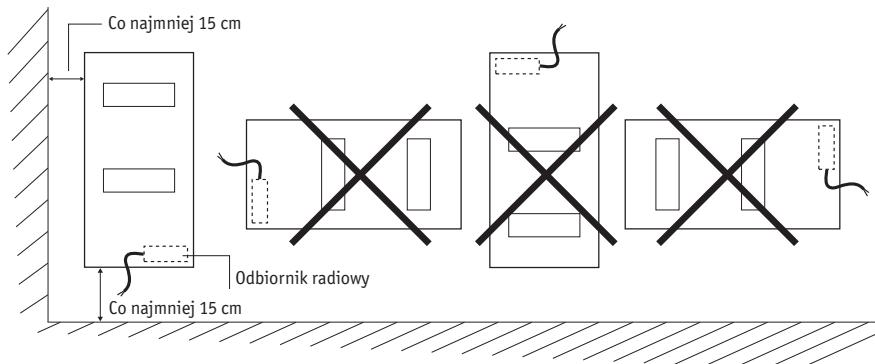
**WAŻNE** Ta suszarka na ręczniki nie powinna być nigdy instalowana z układem zasilającym do góry. Umieścić dół suszarki na ręczniki na wysokości wynoszącej co najmniej 15 cm od podłoża.
