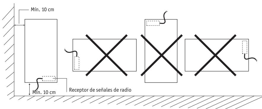
**IMPORTANTE** Este radiador no debe instalarse nunca con su caja de alimentación en una posición alta. Colocar la parte inferior del radiador a 10 cm del suelo como mínimo.
