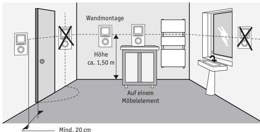
Für eine optimale Einstellung der Raumtemperatur muss der Thermostat im selben Raum wie das Gerät bzw. wie die Geräte, die er steuert, installiert sein.
