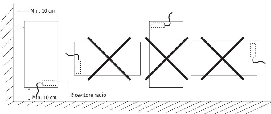
**IMPORTANTE** Questo radiatore non deve mai essere installato con la centralina d'alimentazione in posizione alta. Posizionare la parte inferiore del radiatore ad almeno 10 cm dal pavimento.
