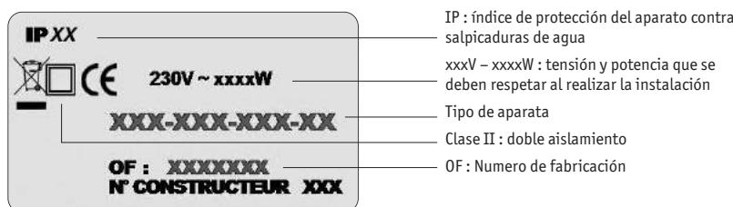
La conexión a la red eléctrica se debe efectuar respetando :
