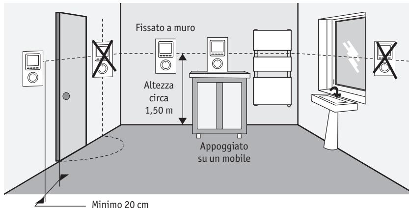
Per una regolazione ottimale della temperatura ambientale, il termostato deve essere installato nella stessa stanza che accoglie gli apparecchi comandati da quel termostato. L'emissione radio consente di oltrepassare gli ostacoli (mobilia, parete divisoria...) da 100 a 300 metri in campo libero, distanza che può variare in funzione delle condizioni di installazione e dell'ambiente elettromagnetico.
