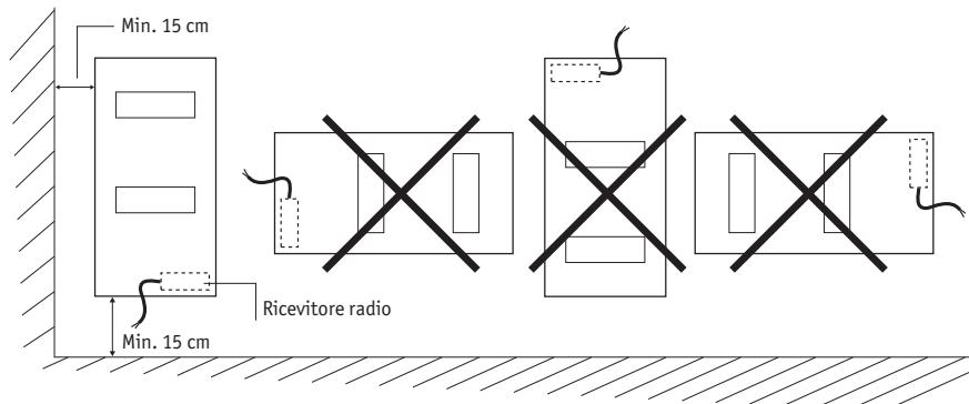
**IMPORTANTE** Questo scaldasalviette non deve mai essere installato con la centralina d'alimentazione in posizione alta. Posizionare la parte inferiore dello scaldasalviette ad almeno 15 cm dal pavimento.
