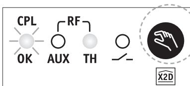
Die Leuchte TH brennt stetig (Der Heizkörper ist mit dem Raumthermostat verknüpft), die Leuchte PLS blinkt: das System wartet auf die Verknüpfung mit der PLS Steuereinheit.
