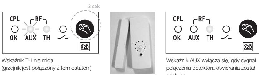
**NALEŻY ODNOTOWAĆ, ŻE** Możliwe jest połączenie do 8 detektorów na kanale AUX.
