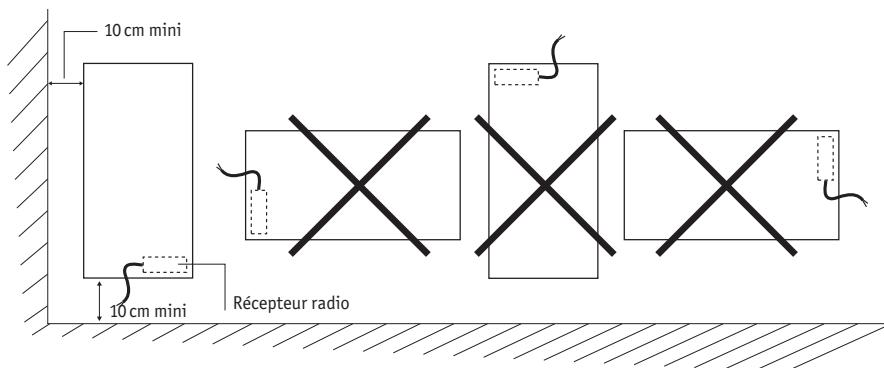
**IMPORTANT** Ce radiateur ne doit jamais être installé avec son boîtier d'alimentation en position haute. Positionner le bas du radiateur au minimum à 10 cm du sol.
