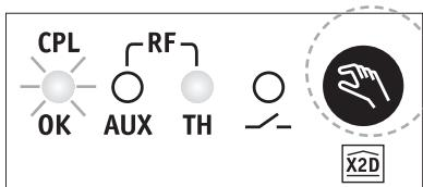
Het controlelampje TH brandt onafgebroken (de radiator is verbonden met de thermostaat), het controlelampje CPL knippert in afwachting van aansluiting op de PLC centrale.
