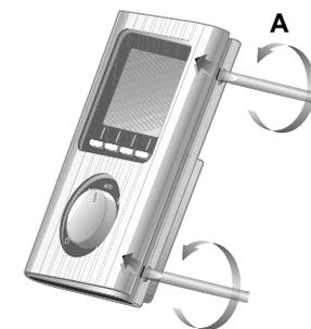
Fixez le thermostat à l'aide de vis et de chevilles ou sur une boîte d'encastrement (B : entraxe de 60 mm).
