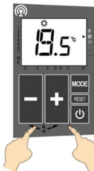
Appui simultané **5 secondes** sur + et - pour activer ou désactiver la fonction.
