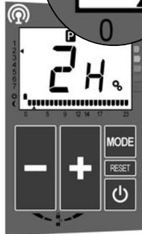
L'indicateur de mode se positionne sur Éco et passe à l'heure suivante.
