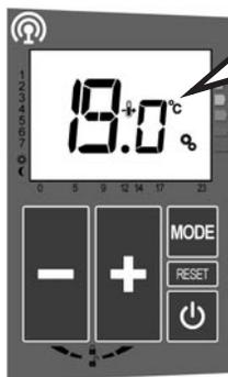
Sinon la fonction étalonnage affiche la température mesurée par votre appareil.
