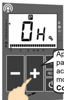
Appui sur + : passe l'heure active en mode **Confort**.
