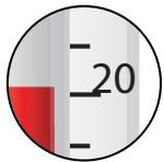
Dans cet exemple on constate 1° d'écart entre la température souhaitée et celle mesurée dans la pièce. Afin de rétablir une mesure correcte de la température ambiante par le radiateur, il faudra entrer 20° comme paramètre d'étalonnage (voir la procédure ci-après).
