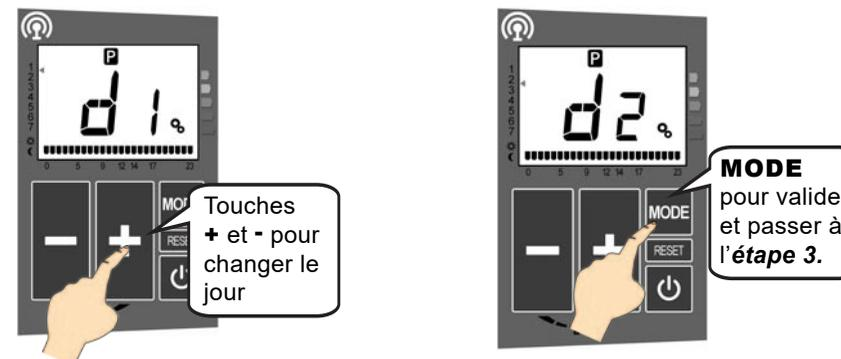
Il est nécessaire de **régler l'horloge** avant de configurer un programme utilisateur (voir **chapitre 6**).
