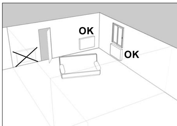
Après avoir ouvert une fenêtre, votre appareil devrait détecter la baisse de température liée à celle-ci dans un délai raisonnable. Il va alors adapter son mode de fonctionnement en passant automatiquement en température hors-gel (7°C). Dans ce cas l'icône « détection d'ouverture fenêtre »
