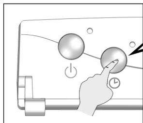
Appuyer **10 secondes** sur le bouton **3** lorsque l'appareil est à l'**arrêt**.
