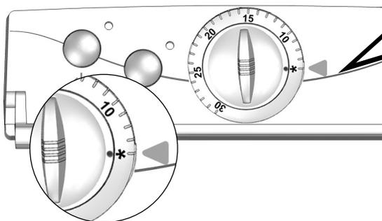
Faire coïncider le point en relief situé sur le bouton de réglage de la température **6** avec le symbole hors-gel de la bague d'étalonnage **7**.
