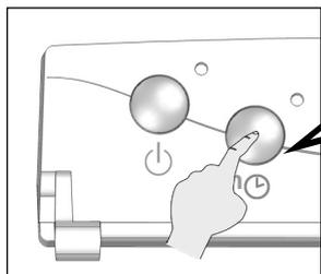
Appuyer **5 secondes** sur le bouton marche forcée **3** : le boost manuel démarre et l'heure d'appui est enregistrée.
