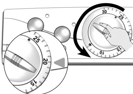
Bloquer le bouton de réglage de la température **6** et faites tourner la bague d'étalonnage **5** **uniquement** afin de positionner l'indication 20°C en face de la flèche repère de réglage **7**.
