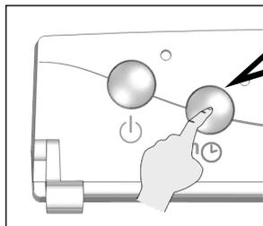
Appuyer **5 secondes** sur le bouton marche forcée **3** durant l'exécution d'une marche forcée (manuelle ou programmée).
