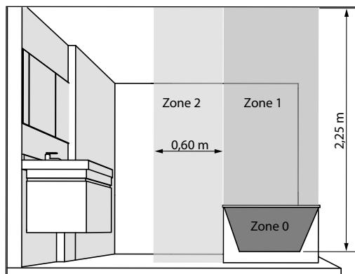
De elektrische voeding moet worden beschermd door een aardlekschakelaar voor maximaal 30 mA, met name bij installatie in een ruimte met een bad of een douche.
