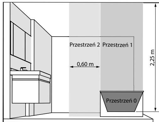
Zasilanie elektryczne powinno być chronione za pomocą bezpiecznikiem różnicowo-prądowym o prądzie zadziałania nie przekraczającym 30 mA, zwłaszcza w przypadku instalacji w pomieszczeniu z wanną lub prysznicem.
