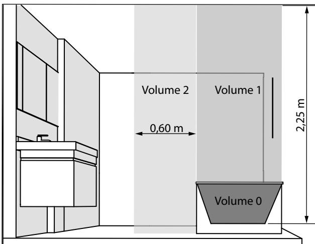
L'alimentation électrique doit être protégée par un dispositif différentiel résiduel de courant assigné au plus égal à 30 mA, notamment dans le cas d'une installation dans un local contenant une baignoire ou une douche.
