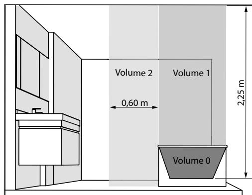
L'alimentazione elettrica deve essere protetta tramite un dispositivo differenziale a corrente residua (DDR) assegnato al positivo, pari a 30 mA, in particolare nel caso di installazione in un locale che contenga una vasca da bagno o una doccia.
