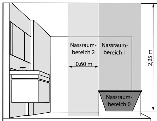
Die Stromversorgung muss über einen FI-Schutzschalter mit einem Bemessungsstrom bis 30 mA gesichert sein, insbesondere bei einer Montage in einem Nassraum mit Badewanne oder Dusche.
