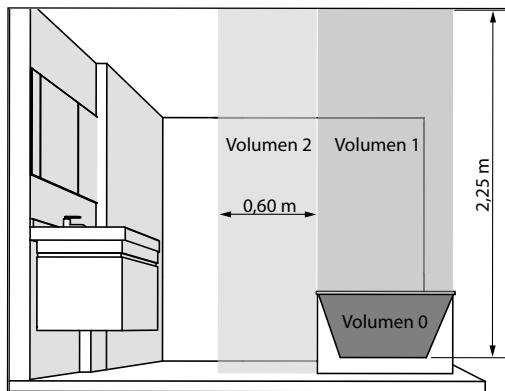
La alimentación eléctrica debe protegerse mediante dispositivo diferencial residual de corriente asignada de 30 mA como máximo, especialmente en caso de una instalación en un local equipado con bañera o ducha.
