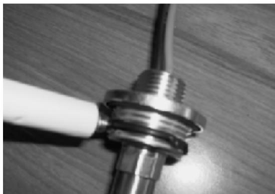
Mettre la pâte Loctite 5 900 (double étanchéité en plus du joint) sur le premier filet et sur un tour. Mettre la résistance en place et serrer la à 5 daN.m.
