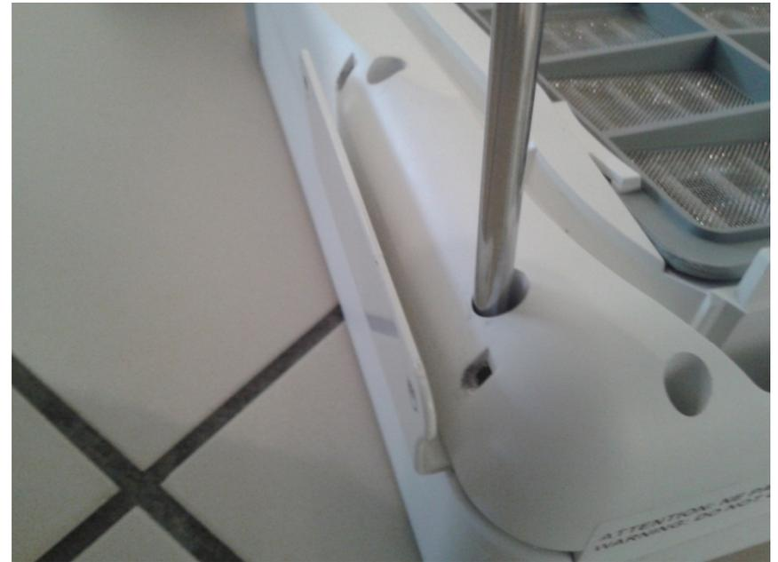
**N'oublier pas de récupérer les fixations du soufflant qui ne sont pas livrées avec la pièce détachée**
