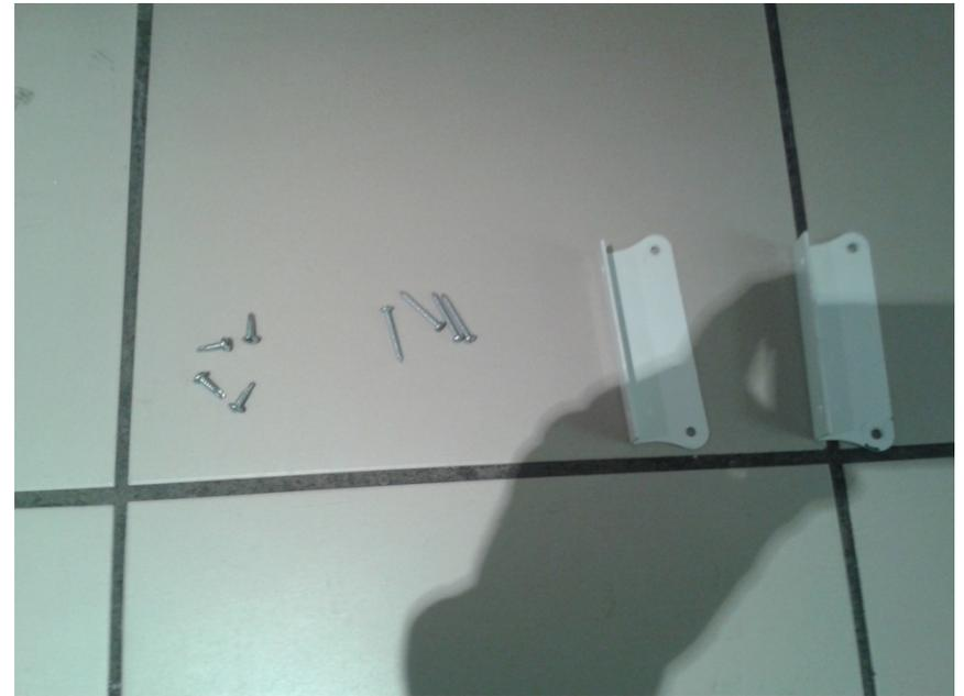
Remonter les ferrures de fixation sur le soufflant neuf
