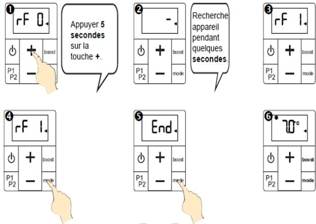
En cas d'échec de l'appairage, l'affichage de la commande revient à rF 0. Vous pouvez alors retenter l'appairage en appuyant 5 secondes sur la touche + (vérifiez avant que l'appareil est toujours prêt à appairer : la LED clignote en magenta). Si l'appairage ne fonctionne toujours pas, contactez votre revendeur.
