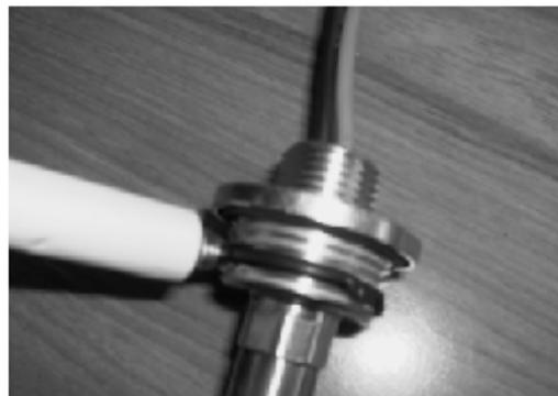
Mettre la pâte Loctite 5 900 (double étanchéité en plus du joint) sur le premier filet et sur un tour. Mettre la résistance en place et serrer la à 3 ou 4 daN.m.
