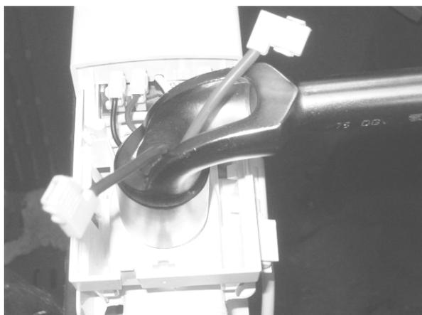
A l'aide de la clé à pipe, retirer l'écrou.
