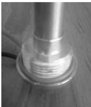
Mettre le joint dans la gorge de la résistance. Le joint de la résistance est différent pour les deux types de radiateur. Pour le TAX le joint est de couleur verte : W20510, pour le TAL de couleur noir : W20530
