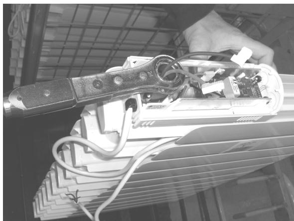
A l'aide de la clé à pipe, desserrer l'écrou.
