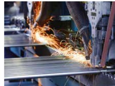
Polissage des soudures
