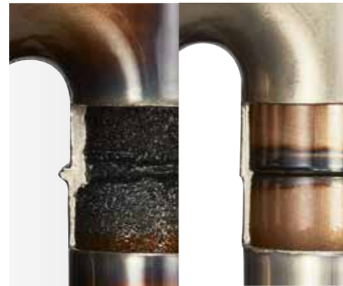
Comparaison entre un système de soudure courant et la soudure laser Zehnder
