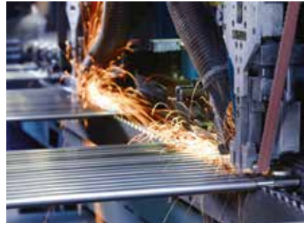
Polissage des soudures
